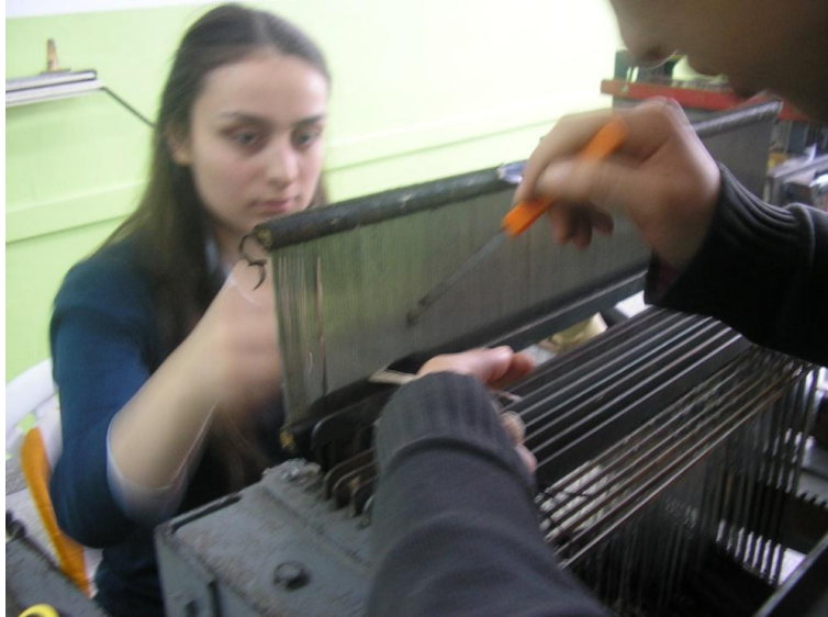
Resim 2. 3: Boyuna yollu örgülü numune kumaş tarak tahar işlemi
